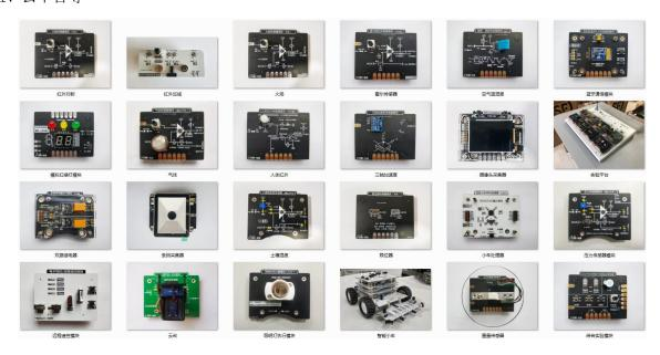
◆ 模块均采用磁吸式接口设计+搭积木式结构,集成标准的 12 路弹性插针,可以实现供电、仿真调试、数据通信、I0 口拓展等功能,同时支持搭积木式的多级磁吸联接,通过弹性插针即可通信,无须外接跳线,通过模块相互搭积木,组成一套完整的物联网系统,如: STM32 处理器+ZigBee 无线模块+传感器模块(3 层垂直积木,无须额外接线),可拓展性强,如下图所示:
